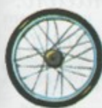
le moyeu et les rayons de la roue
